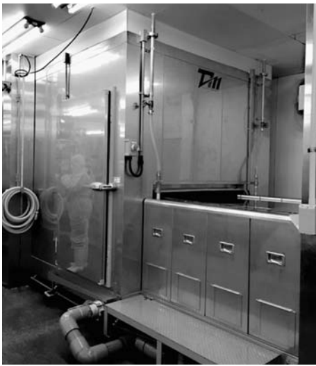
世界的にも珍しいCO 2 直膨式のフリーザー
